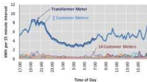
Figura 3. Curva del balance de energía para un transformador de distribución. [Grafica tomada del software de control de energía de EEPG].
